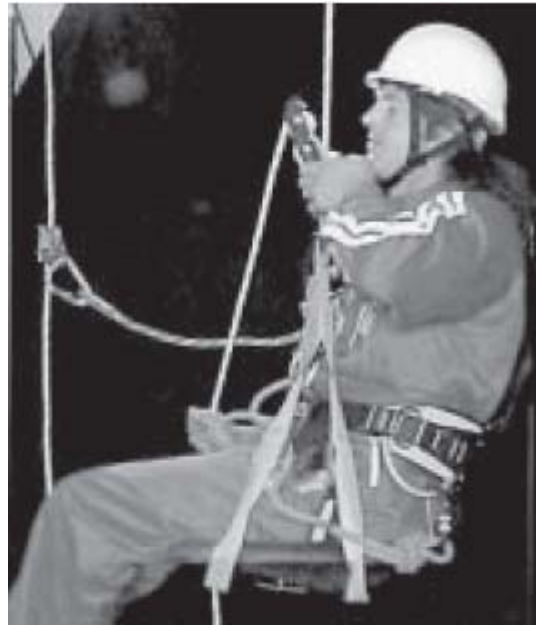
Figura 1 Descenso mediante descendedor autoblocante y dispositivo anticaídas
