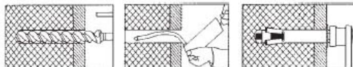
Los anclajes químicos se instalan rellenando el taladro hecho con resinas e introduciendo un perno metálico roscado antes de que se solidifique la resina. Terminan de forma similar a los anclajes mecánicos. Su uso es recomendado en soportes como el hormigón o piedra poco compactos y
