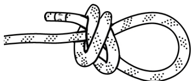
a) Nudo de andamio con doble vuelta: suelto vuelta: suelto
