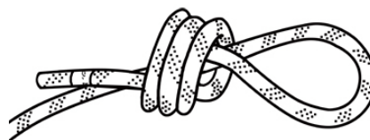
c) Nudo de andamio con triple vuelta: suelto
